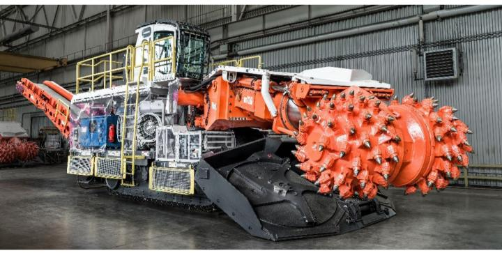
**SANDVIK MINING AND CONSTRUCTION G.M.B.H.** in Zeltweg entwickelt und produziert Vortriebs- und Gewinnungsmaschinen für den schneidenden Abbau von Mineral- und Erzlagerstätten und zur Auffahrung von Verkehrstunnel weltweit.
