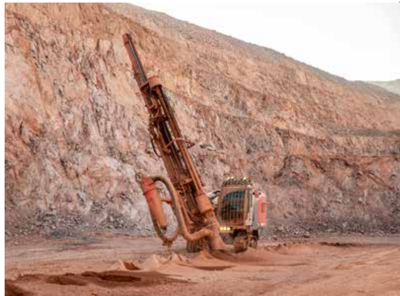
Dos perforadoras inteligentes con martillo de fondo (DTH) Leopard DI650i trabajan en la mina de oro a rajo abierto La Herradura. La mina también tiene dos perforadoras DTH Leopard DI550 (arriba).
