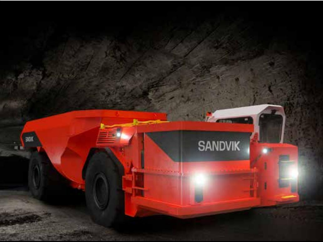
山特维克 TH550B 具有电池更换功能。在电池耗尽时，可以在10分钟内换上充满电的电池。
