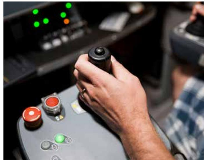
Carregamento e descarregamento são feitos remotamente a partir da superfície com o sistema Sandvik AutoMine Lite na Kidd Operations.
