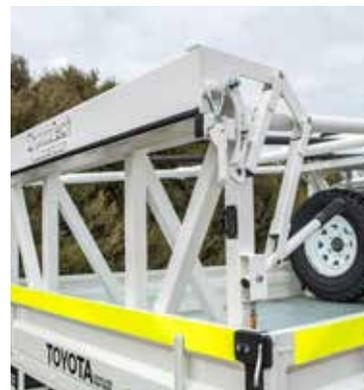
O novo design permite que as hastes de perfuração sejam transportadas com segurança, sem que deslizem ou caiam do veículo.
