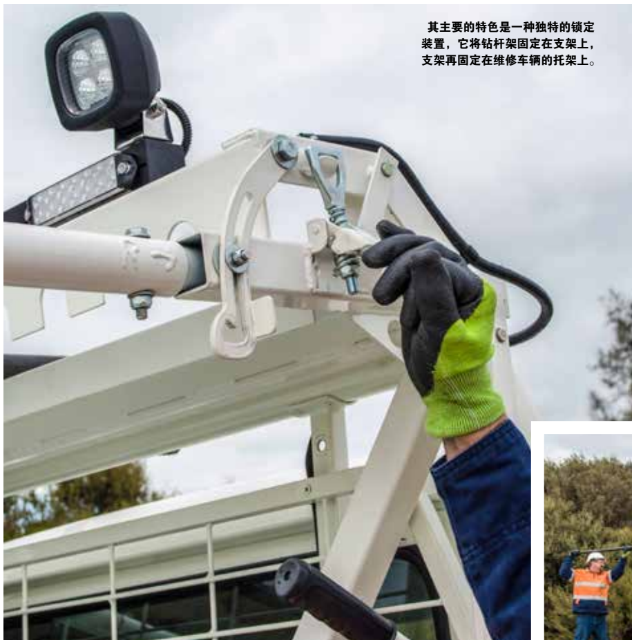
它采用新型设计，维修技术人员能够安全地运输钻杆，而不会使其左右移动或从车辆上掉落。
