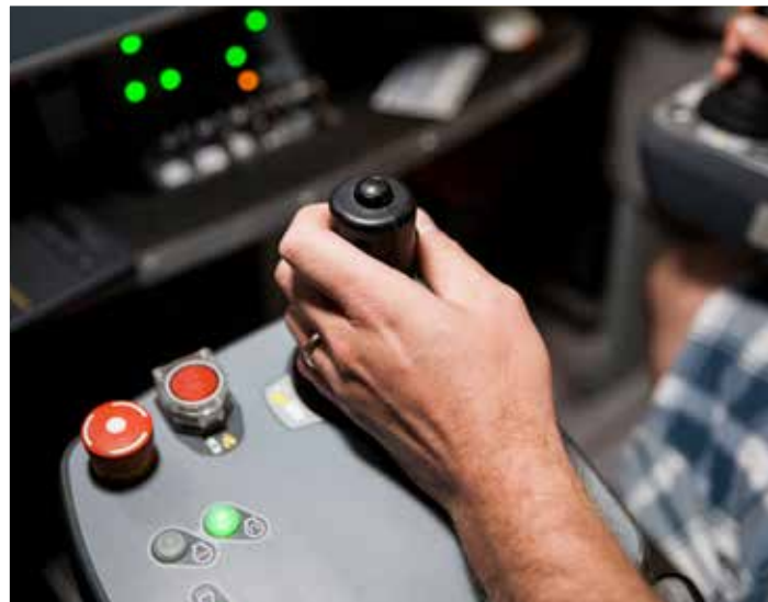
在Kidd Operations，装载和卸载全部通过山特维克 AutoMine Lite 系统，由操作人员在地面远程完成。
