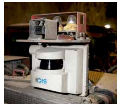
七台机载摄像机和两台扫描仪向地面操作员显示铲运机的情况以便在需要的时候进行干预。
