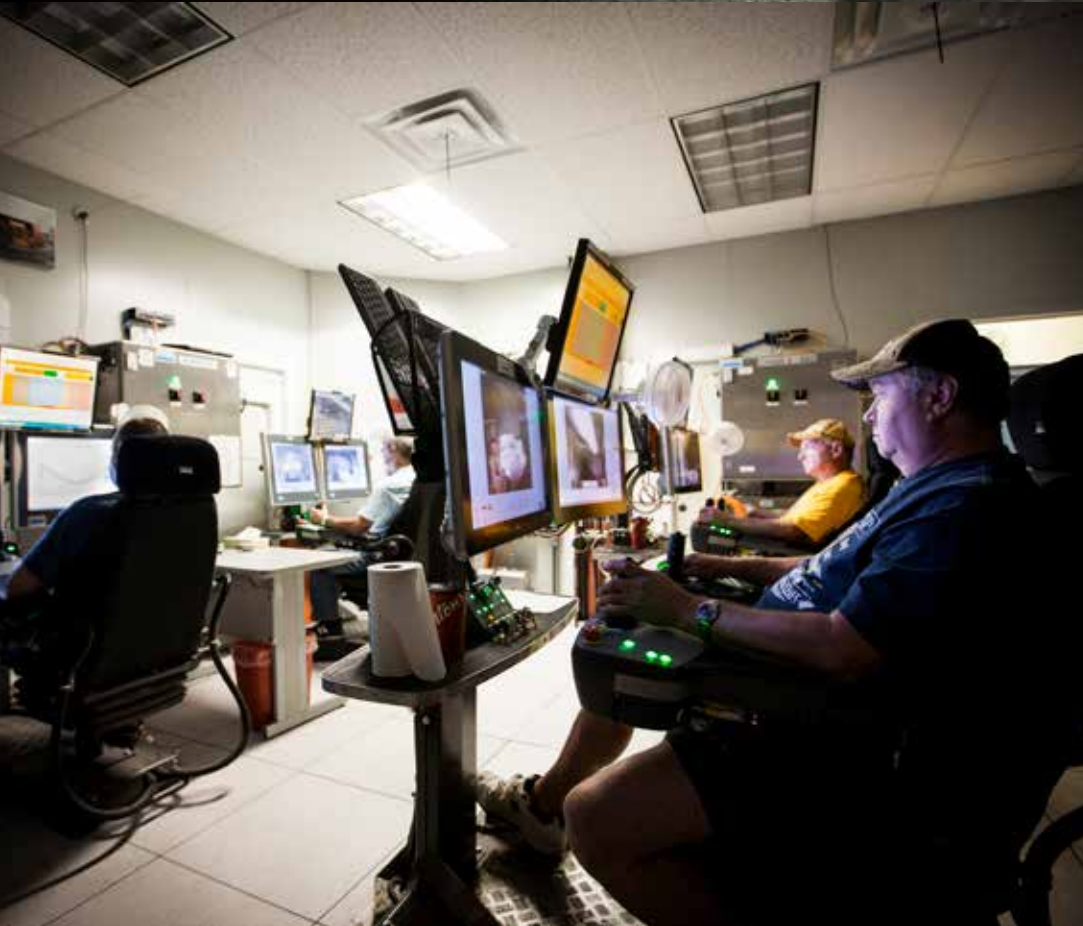
七台机载摄像机和两台扫描仪向地面操作员显示铲运机的情况以便在需要的时候进行干预。
