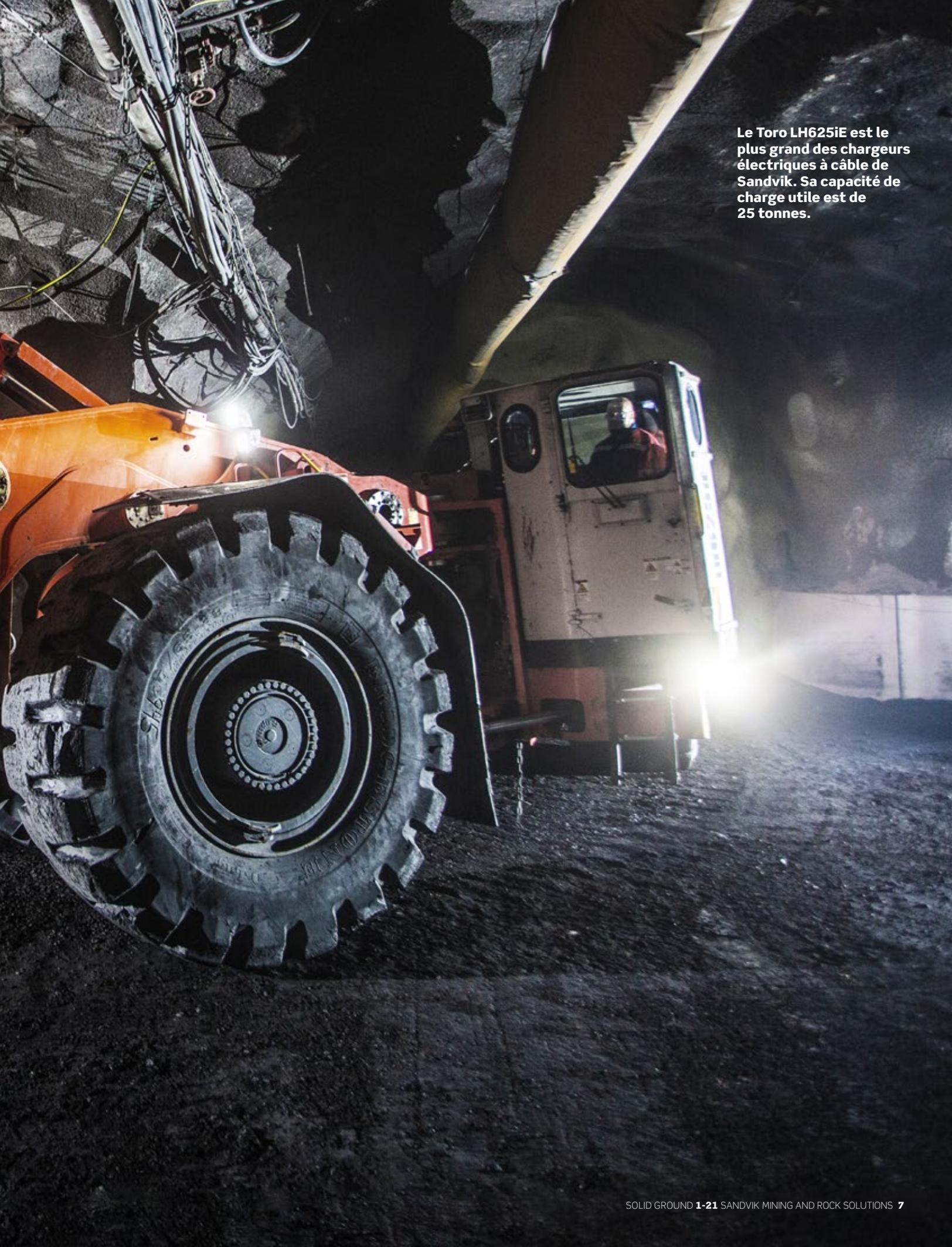
**Le Toro LH625iE est le plus grand des chargeurs électriques à câble de Sandvik. Sa capacité de charge utile est de 25 tonnes.**
