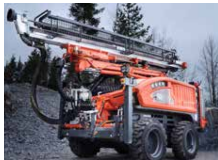
Commando DC130Ri представляет собой гидравлическую самоходную буровую установку с полностью дистанционным управлением.
