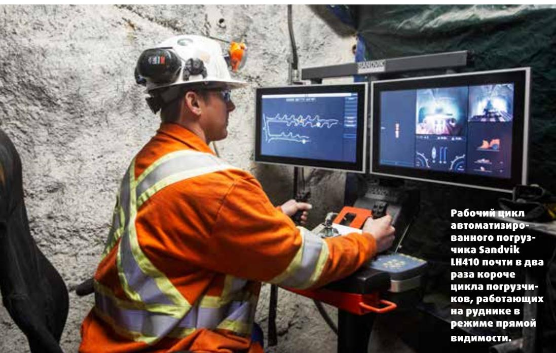
**Рабочий цикл автоматизированного погрузчика Sandvik LH410 почти в два раза короче цикла погрузчиков, работающих в режиме прямой видимости.**
