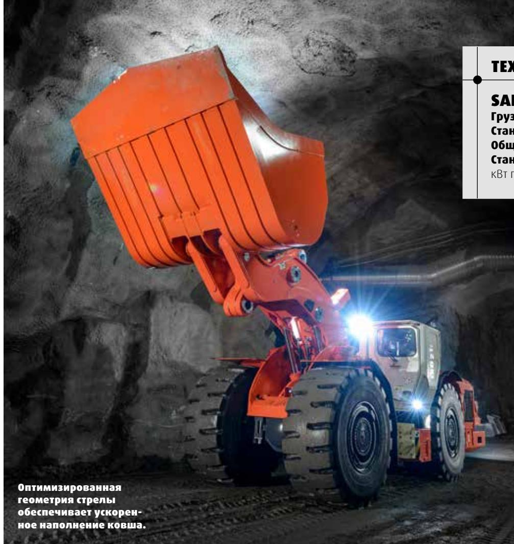
Оптимизированная геометрия стрелы обеспечивает ускоренное наполнение ковша.
