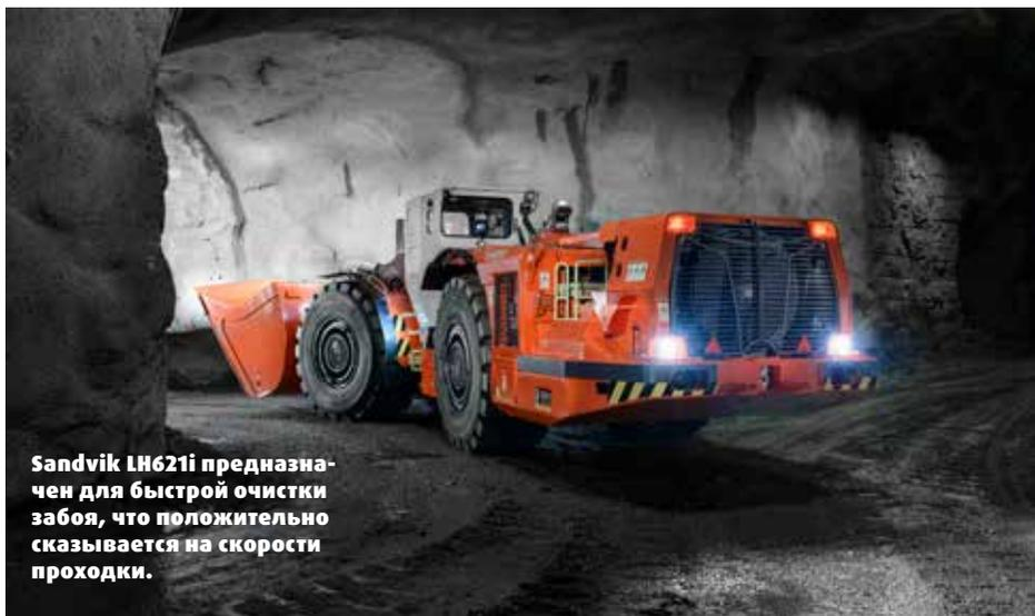
**Sandvik LH621i предназначен для быстрой очистки забоя, что положительно сказывается на скорости проходки.**
