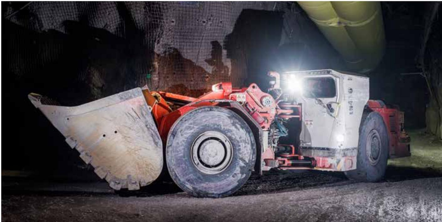
**Уменьшение опасности прорыва обводненной горной массы было основным мотивирующим фактором для внедрения автоматизированной погрузки на руднике Нью-Афтон.**
