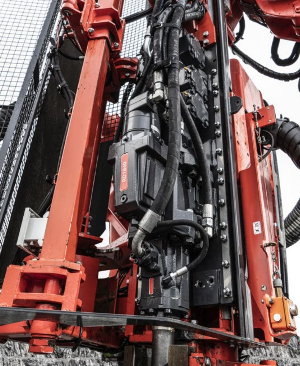
**Rock drill RD1840C telah melewati ribuan jam uji bench, dan keseluruhan rig telah mengebor lebih dari 100.000 meter pada kondisi batuan sulit.**
