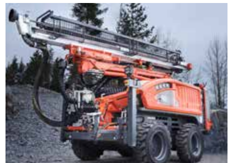
Commando DC130Ri, unidad hidráulica autopropulsada y controlada a distancia.
