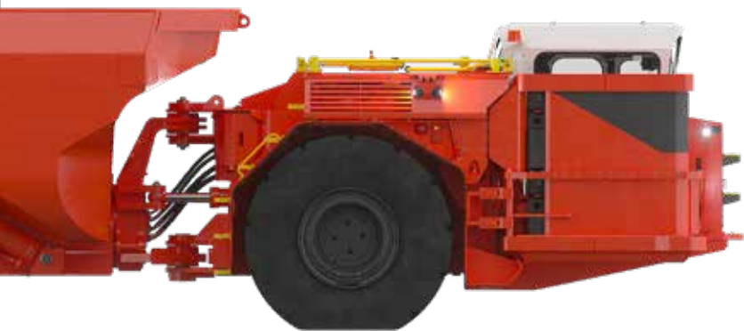
Wóz odstawczy Sandvik TH550B ma ładowność 50 ton
