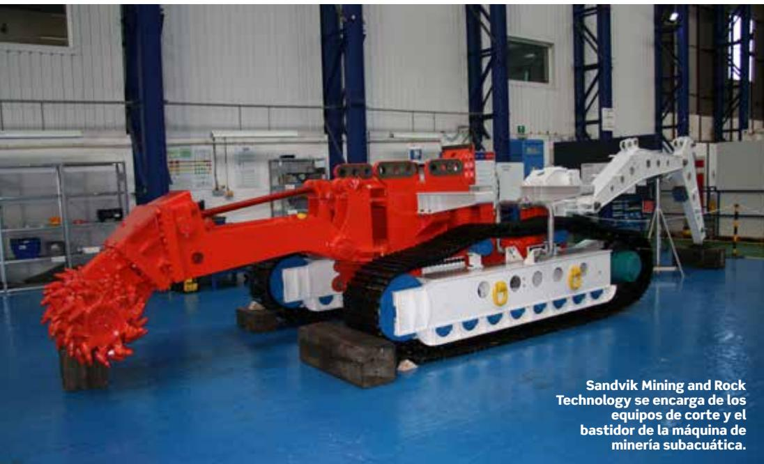
Sandvik Mining and Rock Technology se encarga de los equipos de corte y el bastidor de la máquina de minería subacuática.
