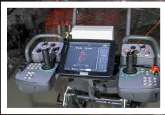
借助山特维克DU412i 控制系统，能够远程进行 矿车驾驶操作、起重臂 和水准测量操作。
