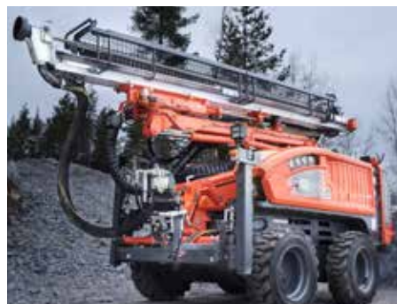
Commando DC130Ri是一台可以完全遥控的液压自行驱动设备。
