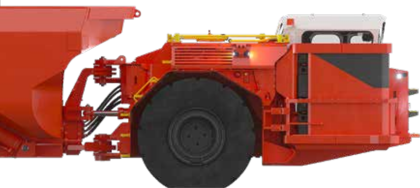
Расчетная грузоподъемность Sandvik TH550B составляет 50 тонн.
