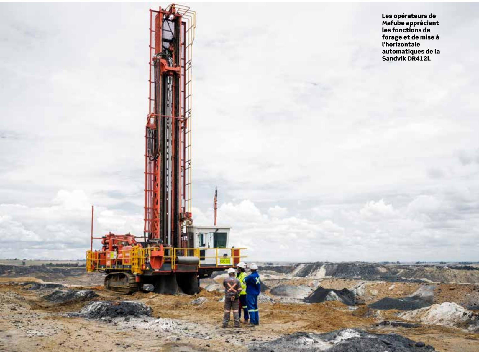
d'une meilleure visibilité. « C'est une foreuse confortable à piloter et son système hydraulique est très bon. Tout s'affiche à l'écran, témoigne le foreur qui a commencé à forer en 2007 sur une Sandvik D25KS. J'aime bien forer en mode automatique avec cette nouvelle foreuse. Il y a moins de commandes. Sur la D25, il faut maintenir le levier jusqu'à ce que le trou soit terminé. »
