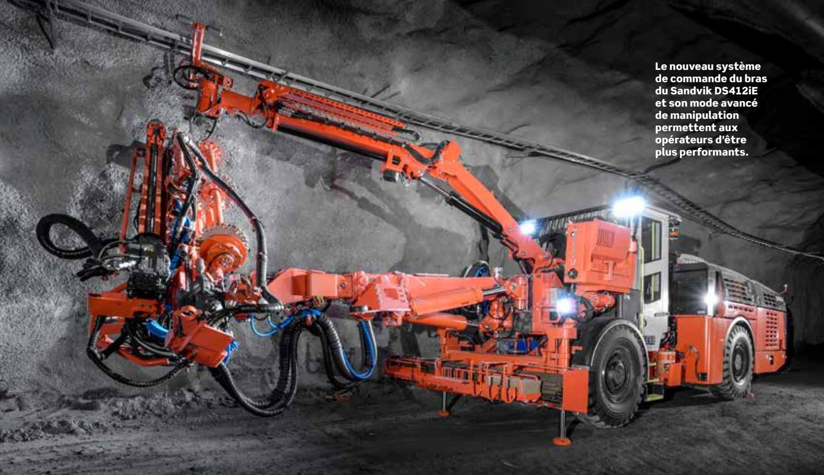
Le nouveau système de commande du bras du Sandvik DS412iE et son mode avancé de manipulation permettent aux opérateurs d'être plus performants.
