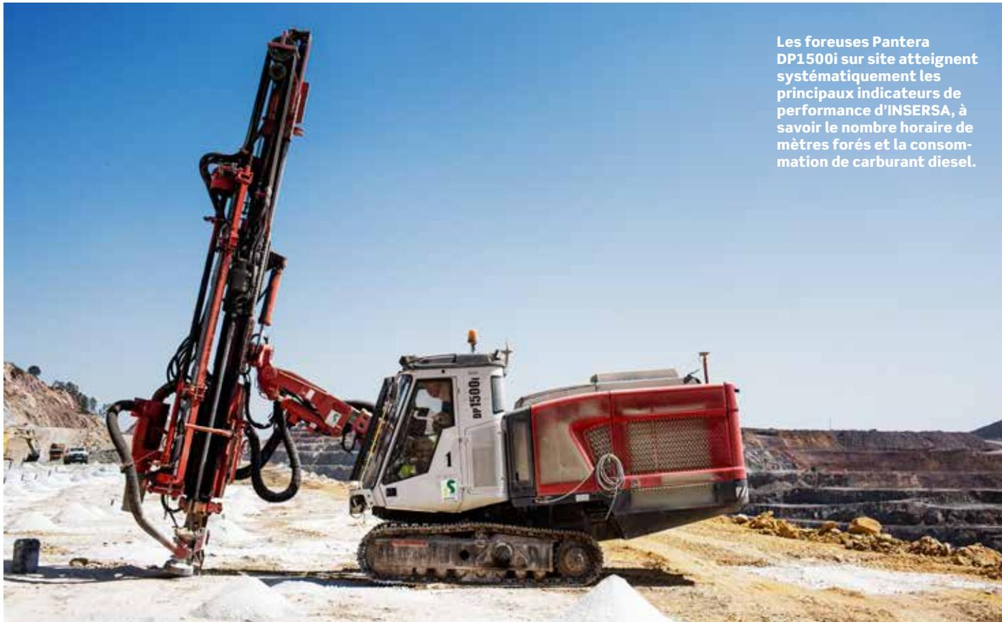
Les foreuses Pantera DP1500i sur site atteignent systématiquement les principaux indicateurs de performance d'INSERSA, à savoir le nombre horaire de mètres forés et la consommation de carburant diesel.
