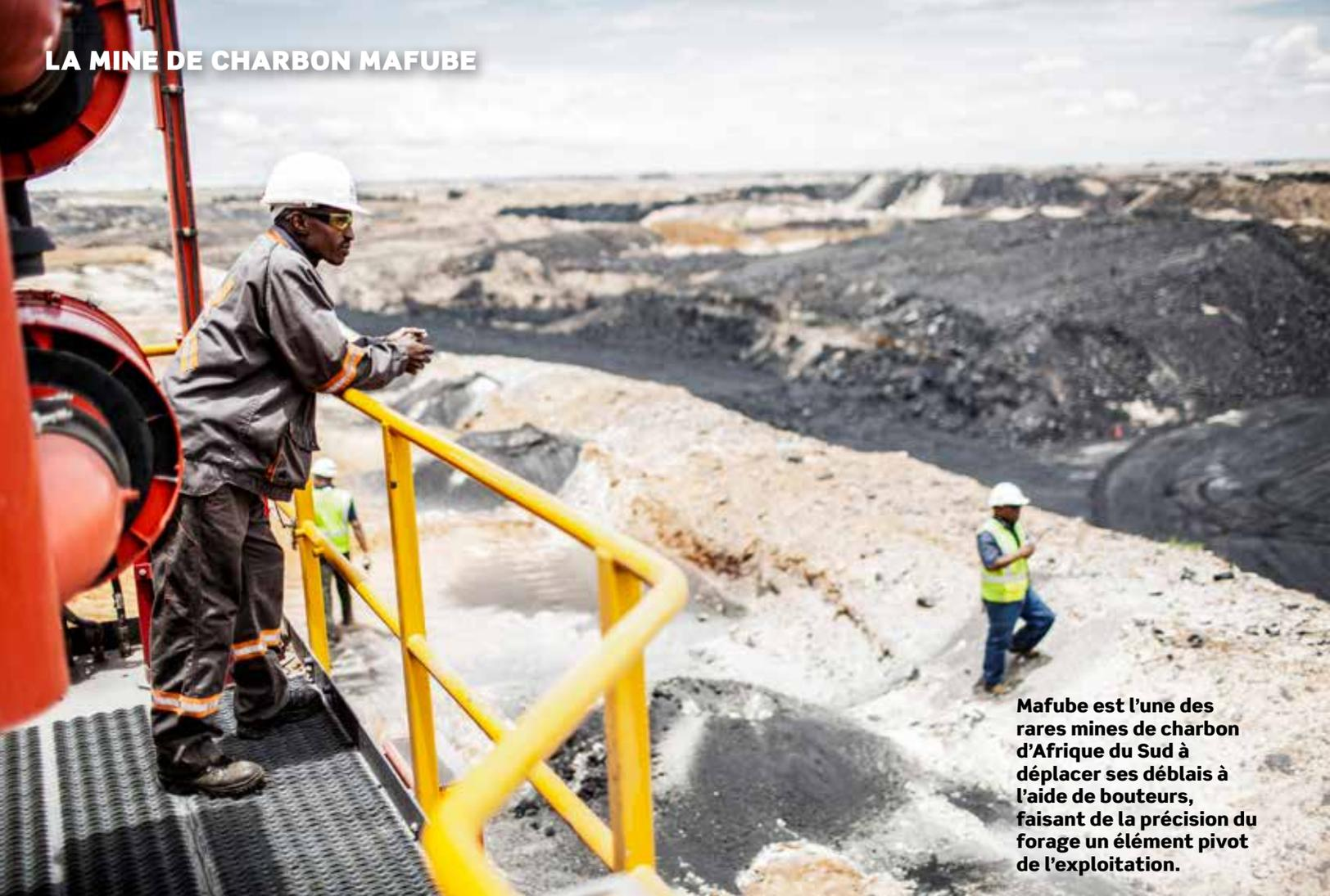
Mafube est l'une des rares mines de charbon d'Afrique du Sud à déplacer ses déblais à l'aide de bouteurs, faisant de la précision du forage un élément pivot de l'exploitation.
