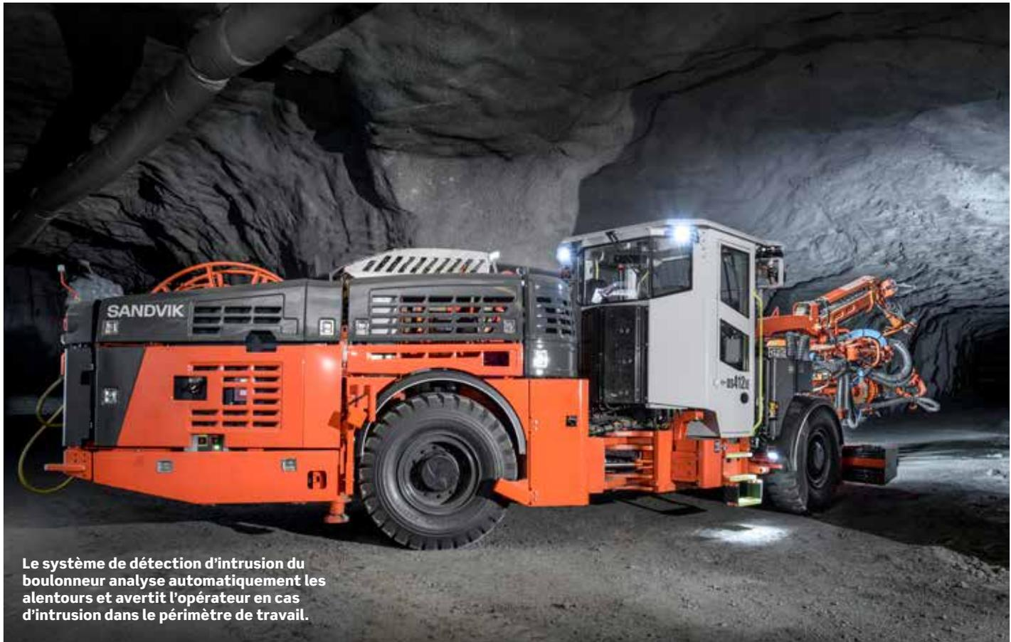
Le système de détection d'intrusion du boulonneur analyse automatiquement les alentours et avertit l'opérateur en cas d'intrusion dans le périmètre de travail.
