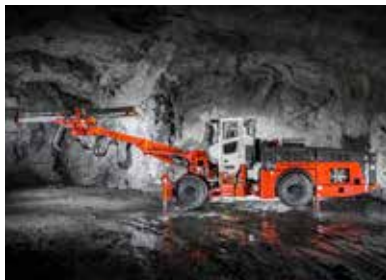
O Sandvik DT912D representa a mais recente tecnologia de tunelamento automatizado
