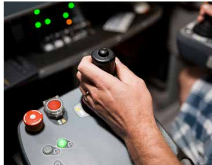
Управление погрузкой и разгрузкой на руднике Kidd Operations осуществляется дистанционно с поверхности с помощью системы Sandvik AutoMine Lite.
