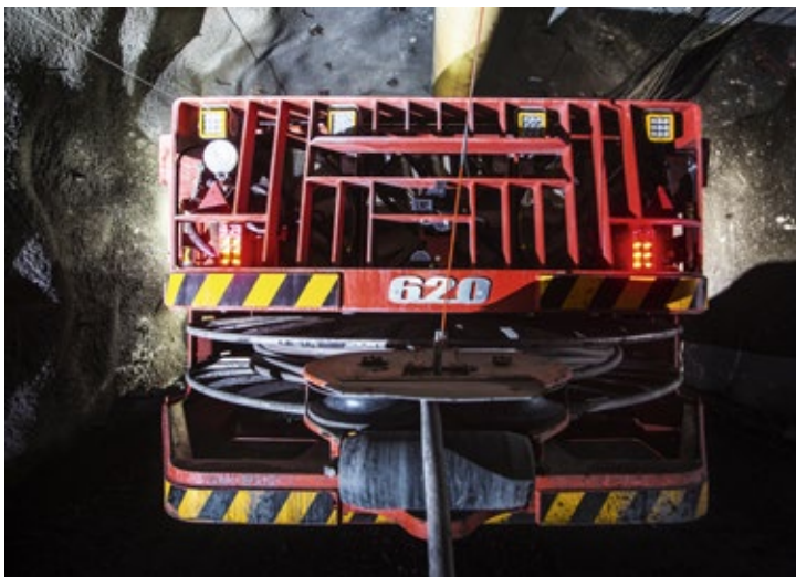
Una de las muchas novedades del Toro LH625iE es el nuevo sistema de bobinado, diseñado para alargar la vida útil del cable umbilical.
