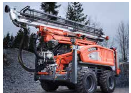
Commando DC130Ri to w pełni zdalnie sterowane, hydrauliczne samobieżne urządzenie wiertnicze
