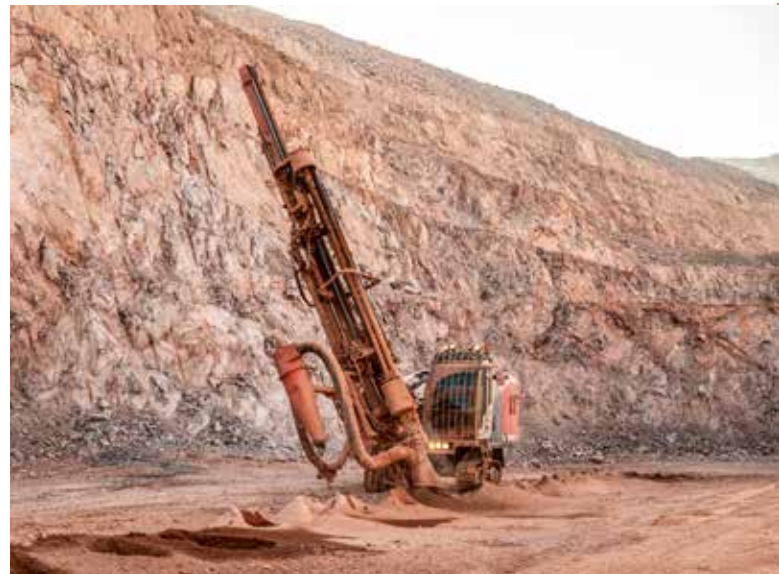
Dagbrottet La Herradura använder två Leopard DI650i intelligenta down-the-hole DTH-borrhigggar för guldbrytning och två Leopard DI550 DTH-borrhigggar.
