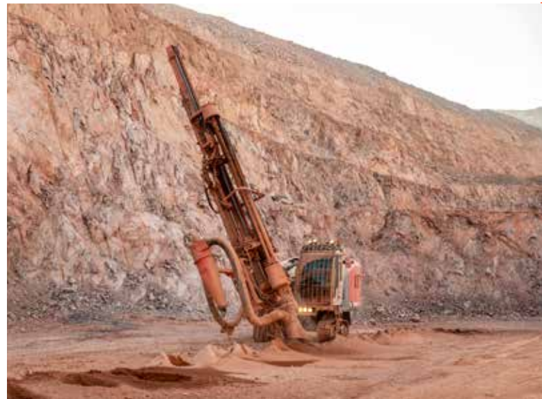
Dua drill rig Leopard DI650i intelligent down-the-hole (DTH) dioperasikan di tambang emas open-pit La Herradura. Lokasi tambang itu juga mengoperasikan drill rig Leopard DI550 DTH (atas).
