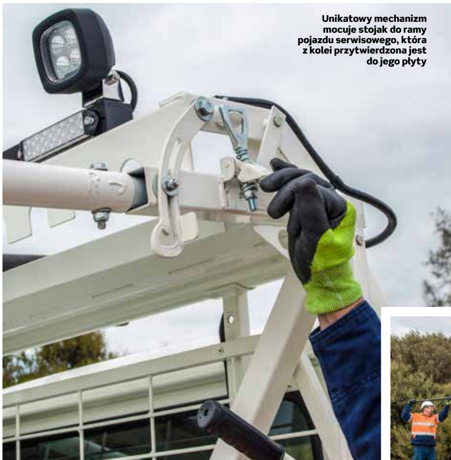
Nowa konstrukcja umożliwia bezpieczny transport żerdzi wiertniczych, zapobiegając ich przesuwaniu się lub wypadaniu z pojazdu
