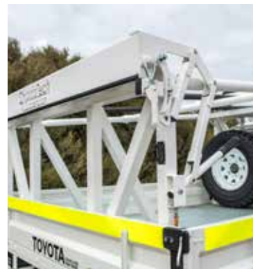
Nowa konstrukcja umożliwia bezpieczny transport żerdzi wiertniczych, zapobiegając ich przesuwaniu się lub wypadaniu z pojazdu
