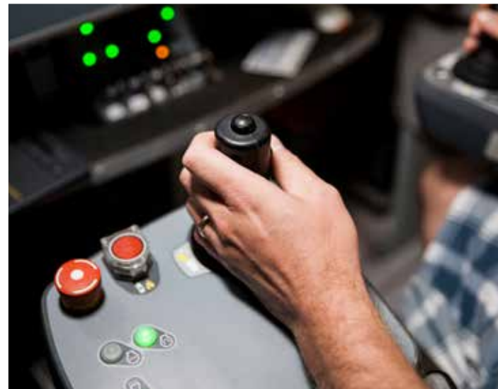
Ładunek i rozładunek w kopalni firmy Kidd Operations są sterowane zdalnie z powierzchni za pomocą systemu Sandvik AutoMine Lite
