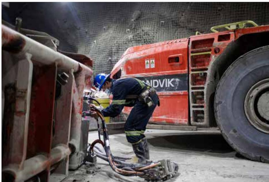
**A troca de bateria permite que a New Afton distribua a energia de carregamento por longos períodos, ajudando a mitigar o alto consumo de energia das soluções de carga rápida.**
