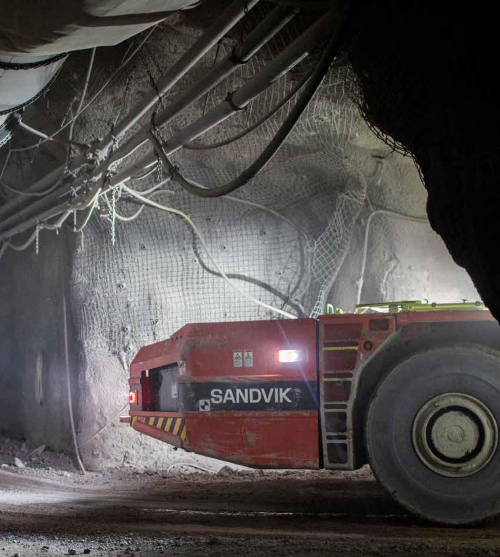
A Sandvik LH518B, carregadeira elétrica a bateria de 18 toneladas, é o primeiro veículo elétrico na mina New Afton, da New Gold.
