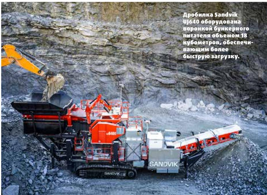
**Дробилка Sandvik UJ640 оборудована воронкой бункерного питателя объемом 18 кубометров, обеспечивающим более быструю загрузку.**
